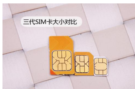
图 2.4-1 三代 SIM 卡尺寸
