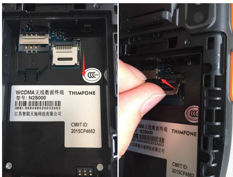
图 2.5-1 安装 T-flash 步骤-1
