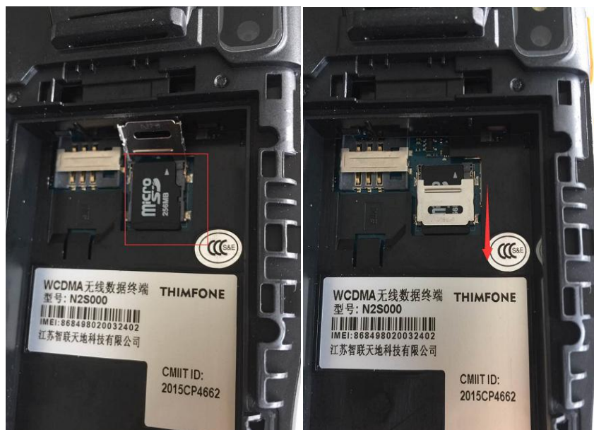
图 2.5-2 安装 T-flash 步骤-2
