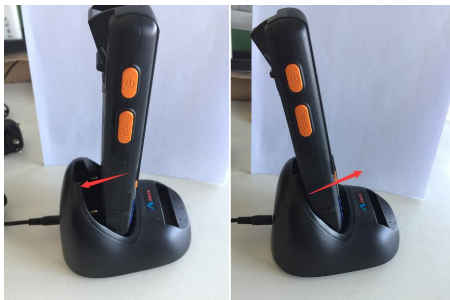
图 2.7-2 正确使用座充充电器
