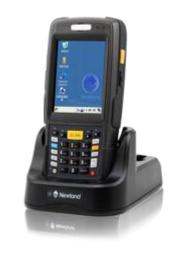
HF-RFID 使用 13.56MHZ 频段,符合 ISO14443A/B 或 ISO15693 标准规范,适用于门禁卡或大部分短距离接触 RFID 应用。NLS-MT70 系列移动数据终端具备 IP65 工业防护等级,预装 Microsoft Windows CE. NET 6.0 操作系统,配备 Marvell XScale PXA310 806MHz 高速处理器及 2GB 大容量用户存储空间,拥有独具特色的模块化结构设计,可方便客户进行定制化拓展。NLS-MT70 支持 WiFi/Bluetooth/ GPRS 等多种通讯方式,可广泛应用于仓储、物流、停车、快递等众多领域。
